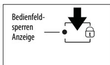
Diese Funktion sperrt die Tasten, um eine unbeabsichtigte Aktivierung des Gerätes zu verhindern. Berühren Sie zur Aktivierung der Bedienfeldsperre die Taste „Bedienfeldsperre“; ein akustisches Signal ertönt und Anzeige leuchtet im Display auf. Das Bedienfeld ist mit Ausnahme der Abschaltfunktion gesperrt. Zur Deaktivierung der Bedienfeldsperre wiederholen Sie die für die Aktivierung beschriebene Vorgehensweise.
