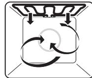
Die Beheizung erfolgt durch den Grillheizkörper. Die Garraumluft wird durch
