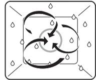
Die Garraumluft wird durch den Heizkörper hinter der Garraumrückwand aufgeheizt und gleichmässig umgewälzt. Der entstehende Dampf wird minimal aus dem Garraum abgeführt. Die Feuchtigkeit des Garguts bleibt erhalten.
