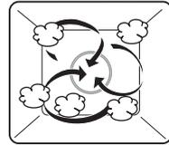
Der Garraum wird gleichzeitig mit Dampf und Heissluft beheizt. Das Gargut wird durch Dampf erhitzt bzw. gegart.
