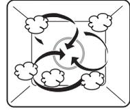
Der Garraum wird mit Dampf und Heissluft beheizt. Das Gargut wird schonend aufgewärmt und trocknet nicht aus.
