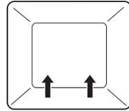
Die Beheizung erfolgt durch den unteren Heizkörper.
