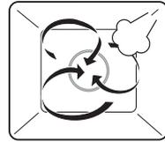
Die Garraumluft wird durch den Heizkörper hinter der Garraumrückwand aufgeheizt und gleichmässig umgewälzt. Durch den kondensierenden Dampf wird die Energie effizienter auf das Gargut übertragen als beim Garen mit Heissluft, wodurch der Garprozess beschleunigt wird. Dampf über 100 °C ist nicht sichtbar.
