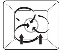
Die Beheizung erfolgt durch Heissluft und Unterhitze. Der Boden des Backguts wird intensiver gebacken.
